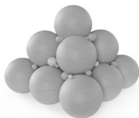
Vereinfachte Darstellung der Packungsdichteoptimierung als Kugelmodell
