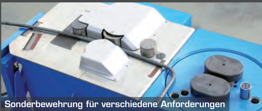
Richten, Schneiden und Biegen bis auf \varnothing 25
