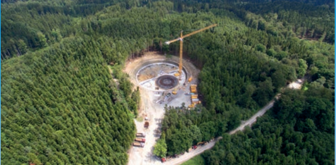
Beim Bau der Windenergieanlage am Standort 3 sind die Konturen des Passivspeichers gut zu erkennen.
